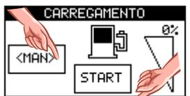
Carregamento manual: pressionando a tecla START exibida no visor ativa-se a saída do carregamento, soltando a tecla a saída desativa-se.
