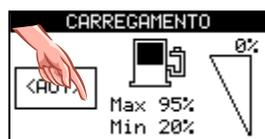
Carregamento automático: quando o nível do combustível desce abaixo do limite do "mínimo nível", ativa-se a saída e aparece no visor a escrita NÍVEL COMBUSTÍVEL MÍNIMO. Com a superação do "máximo nível" a saída desativa-se e aparece a mensagem NÍVEL MÁXIMO DE COMBUSTÍVEL.
