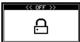
Imagem exibida quando se passa a off. Em OFF o motor não pode ser iniciado de qualquer forma ou se estiver em movimento é parado sem efetuar o arrefecimento motor.
