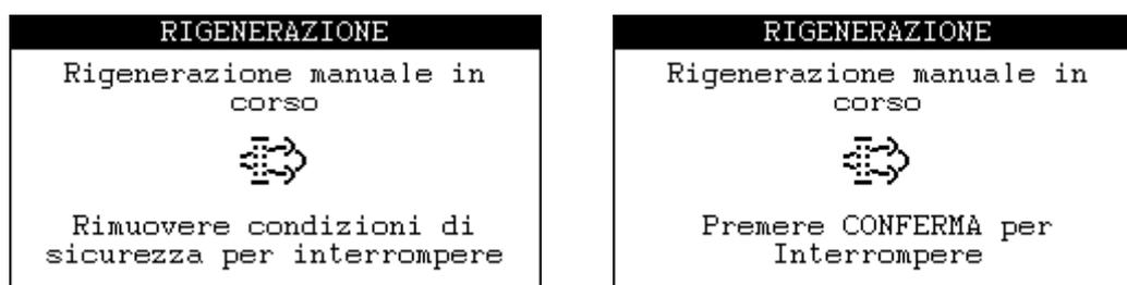
Par l'intermédiaire des signaux de l'instrument LAMPES, il est possible de suivre l'état de la régénération manuelle.
