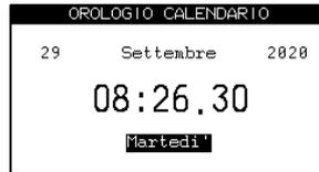
Der hervorgehobene Wert kann mit der TASTE\_AUF und der TASTE\_AB verändert werden. Um die Auswahl zu verändern TASTE\_RE und TASTE\_LI bedienen. Um den Programmiermodus zu verlassen, die TASTE\_AUSSCHLUSS\_PUMPENSCHUTZVORRICHTUNGEN drücken. Eine Bestätigung ist nicht erforderlich. Die Uhrzeit bleibt dank einer internen Batterie auch dann erhalten, wenn die Steuereinheit nicht mit Strom versorgt wird.
