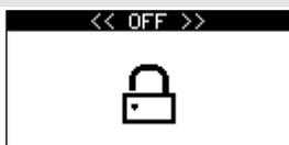
Imagen mostrada cuando se pasa al modo off. En el modo OFF, el motor no puede ser arrancado de ningún modo y, si está en marcha, se para sin que tenga lugar el enfriamiento.
