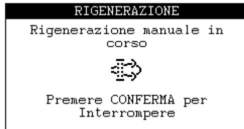
Der Status der manuellen Regeneration kann über die Meldungen im Tool LAMPEN überwacht werden.
