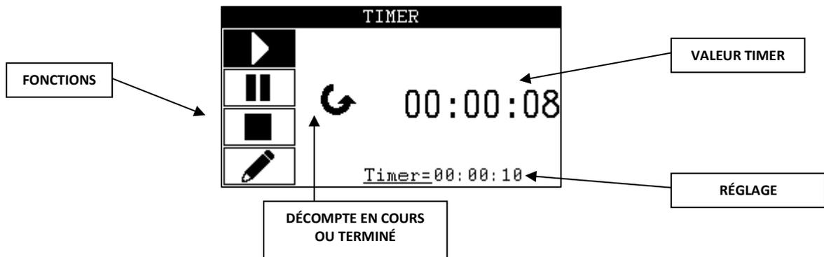
La TOUCHE\_HAUT et la TOUCHE\_BAS permettent de modifier la sélection de la fonction, et la TOUCHE\_CONFIRMATION permet de l'exécuter :
