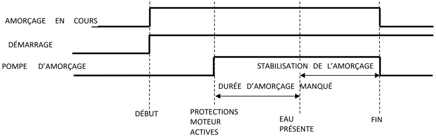
• **AMORÇAGE DE LA POMPE AVEC RÉSERVOIR DE STOCKAGE D'EAU**
