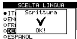
A questo punto il parametro scelto è programmato nella centralina. Le programmazioni sono salvate in una memoria non volatile, quindi vengono mantenute anche togliendo la tensione di alimentazione. E' possibile in ogni momento variare il valore seguendo le procedure sopra elencate.
