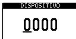
Es muss eine Ziffer nach der anderen eingegeben werden, TASTE\_LI und TASTE\_RE zum Bewegen des Cursors, TASTE\_AUF und TASTE\_AB zum Ändern der Ziffer. Zur Kontrolle die TASTE\_ACK drücken, bis das Ergebnis angezeigt wird:
