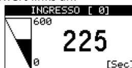
TASTE\_AUF und TASTE\_AB verwenden, um den Wert zu ändern und TASTE\_ACK, um den Wert zu bestätigen:
