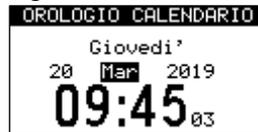
Der hervorgehobene Wert kann mit der TASTE\_AUF und der TASTE\_AB verändert werden. Um die Auswahl zu verändern TASTE\_RE und TASTE\_LI bedienen. Um den Programmiermodus zu verlassen, die TASTE\_SCHILDKRÖTE drücken oder Schlüssel auf OFF stellen. Eine Bestätigung ist nicht erforderlich. Die Uhrzeit bleibt dank einer internen Batterie auch dann erhalten, wenn die Steuereinheit nicht mit Strom versorgt wird.
